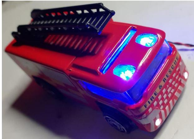
**Feux avant :** Ce camion de pompiers avait en face avant 2 orifices de 2 mm. Il était donc facile d'y monter 2 leds canon de diamètre 2mm (racourcies et poncées) en lieu et place de leds CMS. :
