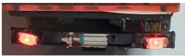
**Feu arrière du camion :** merci de noter que la led de gauche a été collée un peu de travers du vrai travail d'amateur... Fixation de la led : percer un trou d'environ 1mm coller à la colle 21 pour presser avec une pince crocodile.
