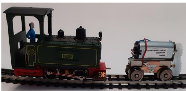
Decauville Stéatite HOe et bogie entraxe de 17mm avec roues de 7mm
